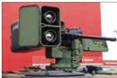
Купола Mini Samson са митраљезом 12,7 мм и две ракете Spike
