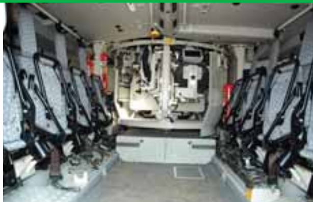
Једноставан распоред: у два реда по четири седишта, са брзим приступом излазу на Patria AMV
