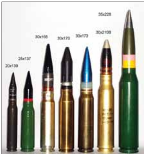
Муниција БВП: 20 x 139 мм са AMX-10P, Marder; 25 x 137 са Bradley, Dardo, YPR-765; 30 x 165 са БМП-2/3; 30 x 170 (Warrior), 30 x 173 (EFV, Pizarro/Ulan, CV9030), 30 x 210B (M-80A) и 35 x 228 (CV9035, Type-89).
